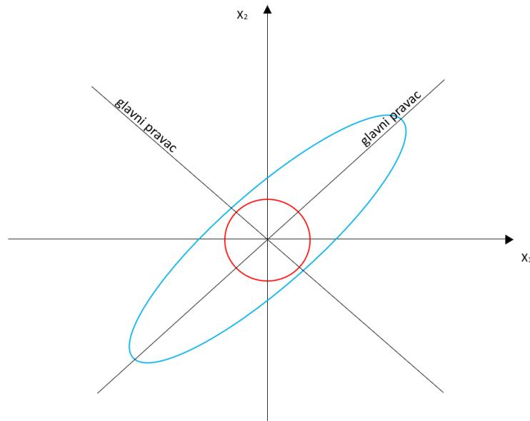
Slika 1.5: Nedeformirana (kružnica) i deformirana (elipsa) membrana
